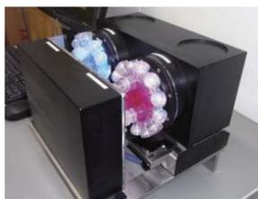
培養器の回転速度を細胞の状態に合わせて制御し、常に細胞塊が浮いた状態を保つ3次元細胞培養装置
