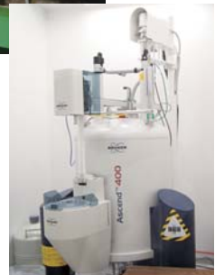
核磁気共鳴(NMR)で 原料の品質を確認する
