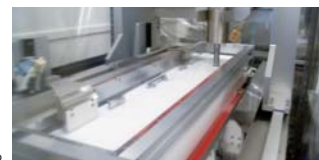
世界最高の集光性能を誇る放射光用X線ナノ集光ミラー
