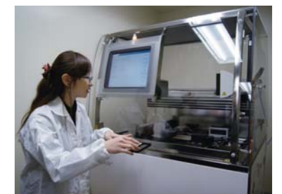
細胞に電流を流し、 薬効を探る装置
